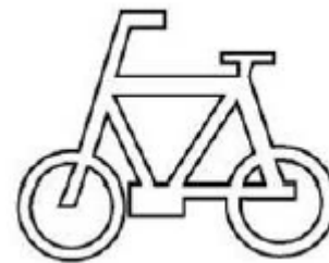
道路標示「普通自転車歩道通行可（114の2）」
