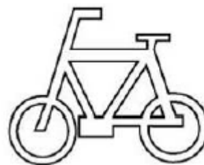
道路標示「普通自転車歩道通行可（114の2）」
