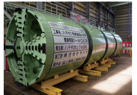
▲流下型貯留管の整備に使用するシールドマシン(管径2,000mm) この機械でトンネルを掘って、管を布設します。
