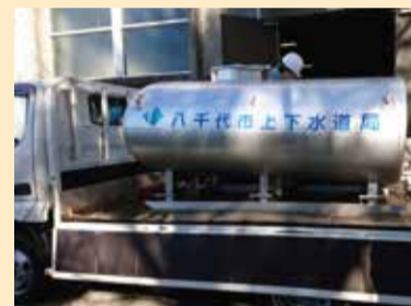
▲給水タンクをトラックに載せる
