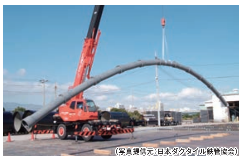
▲耐震管の吊り上げ実験
