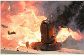
電動アシスト自転車用非純正バッテリーから発火する様子（再現イメージ映像）
