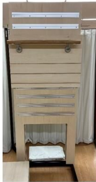
計測に使用した機器。 掴む位置による掴む力の変化等を計測。
