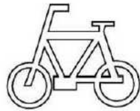
道路標示「普通自転車歩道通行可(114の2)」
