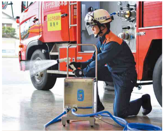
▲オゾン水で、細菌やウィルスなどを安全に分解します。キャリア搭載型なので、災害現場でも使用することができます
