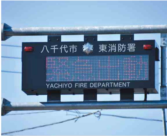
▲車両の出動時に、メッセージを表示、サイレンと音声を流し、通行車両や通行人に注意を促します。注意報などの情報を表示します
