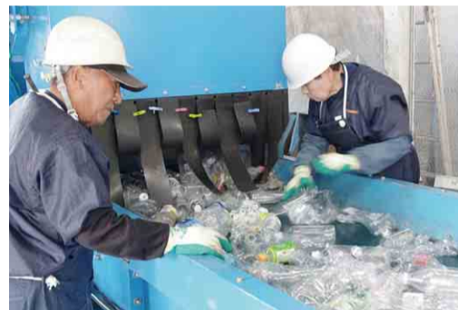
回収したペットボトルから手作業で異物を取り除きます
