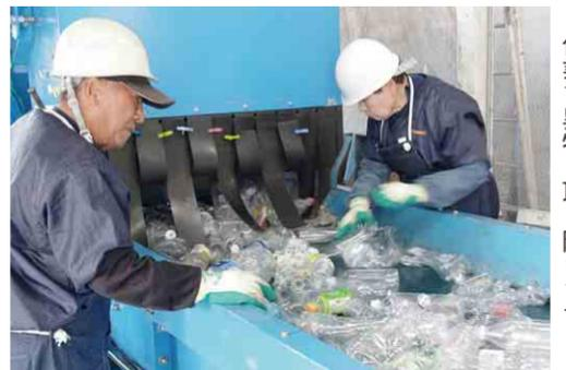
回収したペットボトルから手作業で異物を取り除きます
