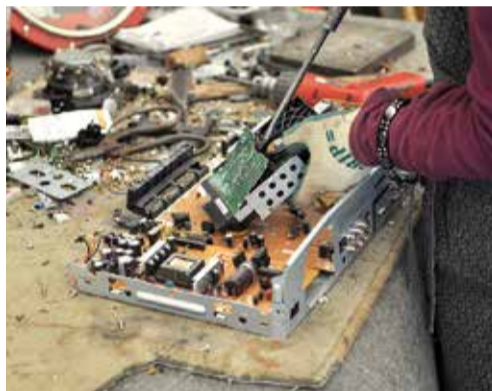
金属類は手作業で取り外され、リサイクルされます
