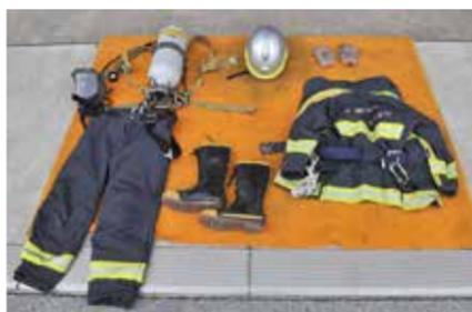
管轄署で指令を確認して出動準備。火事の時は、空気呼吸器を含め、総重量15～20キログラムの防火衣に着替えます。消火に使うホースは一卷20メートル、重さ5キログラムです。
