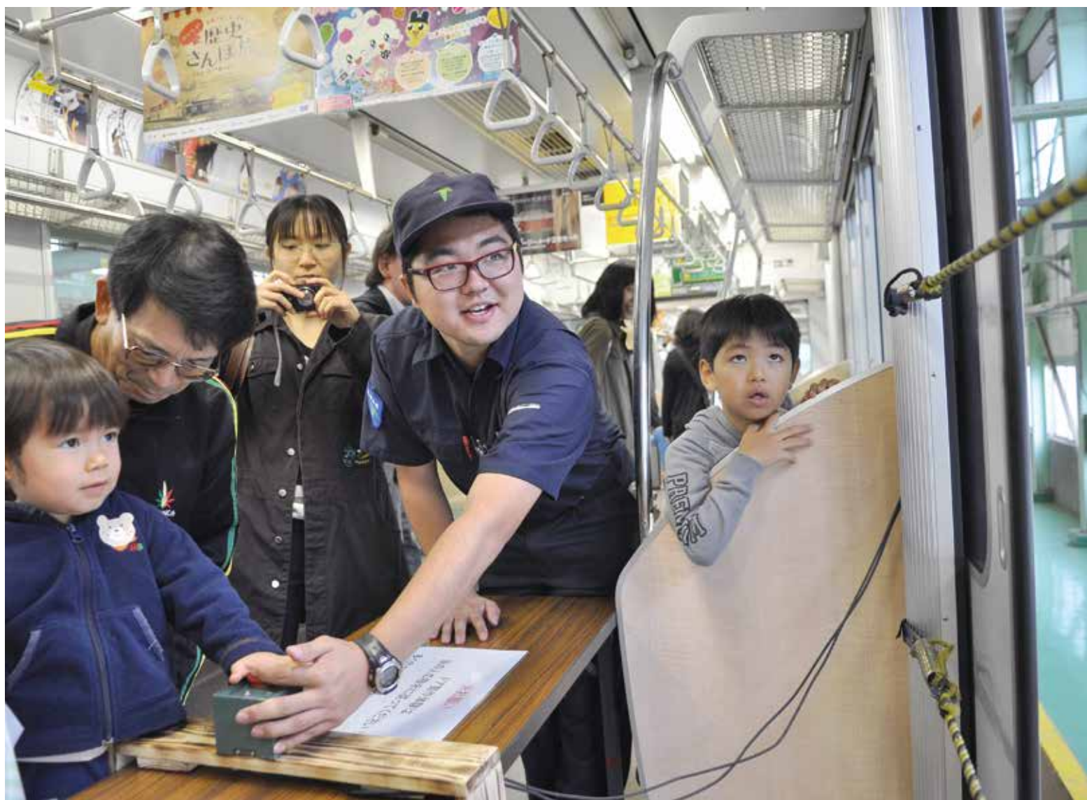
▲車掌が実際に使用するボタンで、ドアの開閉操作を体験。普段は見えないドア上の装置も開放され、係員からドアが開く仕組みを教わりました
