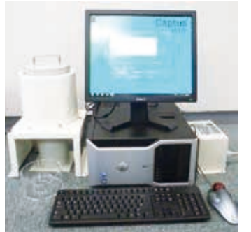
▲測定で使用する米国キャピテック社製CAPTUS-3000A型
