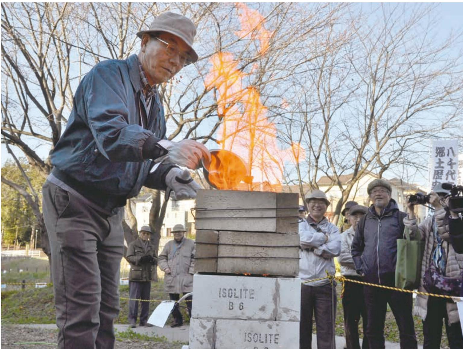
▲製鉄炉に大量の木炭と市内で採れた砂鉄を交互に投入。1,400度近い高温で熱すると、酸化していた鉄が溶け不純物と分離されて、炉の底にたまりま
