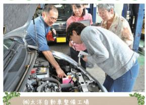
車を実際に持ち込んで、整備技術コンサルタ ントの堀田聡さんに、女性や高齢者でもできる チェックの仕方を教わりました。冷却水、エン ジンオイル、タイヤの溝と空気圧、ヘッドライ トなど 15 項目を点検しました。車に必要なオイ ルや液体は適正量があり、多くても少なくても トラブルの原因となります。また、タイヤの空 気圧が低いと、タイヤの劣化を早めたり、パン クする恐れがあります。
